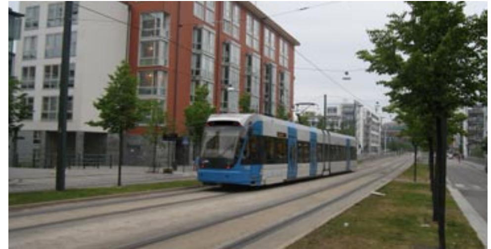
Lugnets allé, Hammarby Sjöstad. Esplanadgata med kollektivtrafik, trädrader, möblerbara trottoarer. Gatusektion 38 m. (6 + 5 + 16 + 5 + 6).
