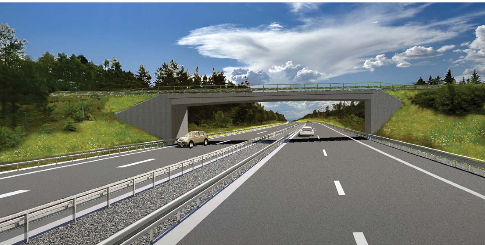
Figur 3-10. Perspektiv som illustrerar passage under befintliga broar efter planerad vägbreddning.
