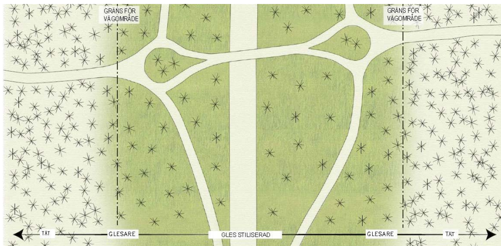
Figur 3-21. Principplan över vegetationshantering vid trafikplatser längs vägsträckan. Från tät befintlig skog till ett mer stiliserat landskap med uppstammade träd och låg undervegetation i trafikplatsen.
