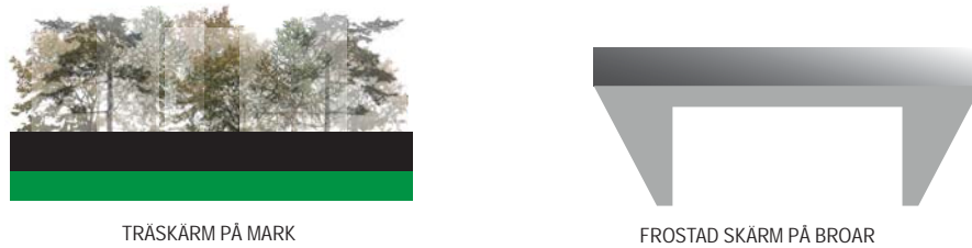
Figur 3-30. Princip för typ av viltskärm på mark och broar.
