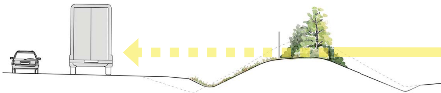
Figur 4-12. Principsektion som illustrerar flerskiktad naturlig plantering med bländskyddsfunktion. Viltskydd placeras mellan väg och plantering (grå markering). Streckad grå linje symboliserar befintlig sektion.
