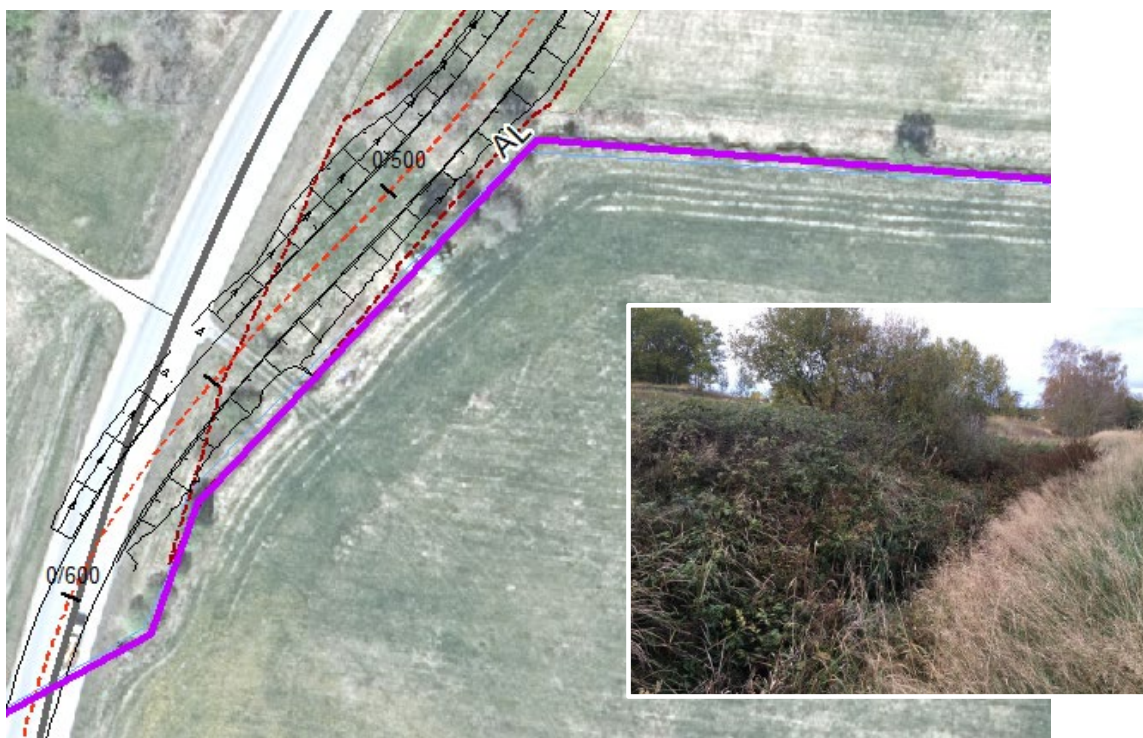
Objekt AL. Öppet dike (lila linje). Övriga ritade linjer markerar väg-/arbetsområde.
