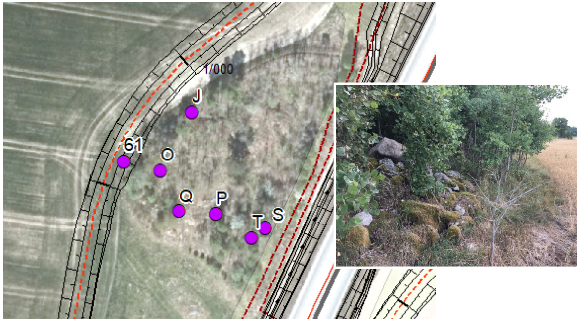
Objekt 61. Odlingsröse (lila punkt) som tas bort kan kompenseras genom att förstärka något av övriga rösen - J, O, P, Q, S, T (lila punkter) - eller i något motsvarande läge. Övriga ritade linjer markerar väg-/arbetsområde.
