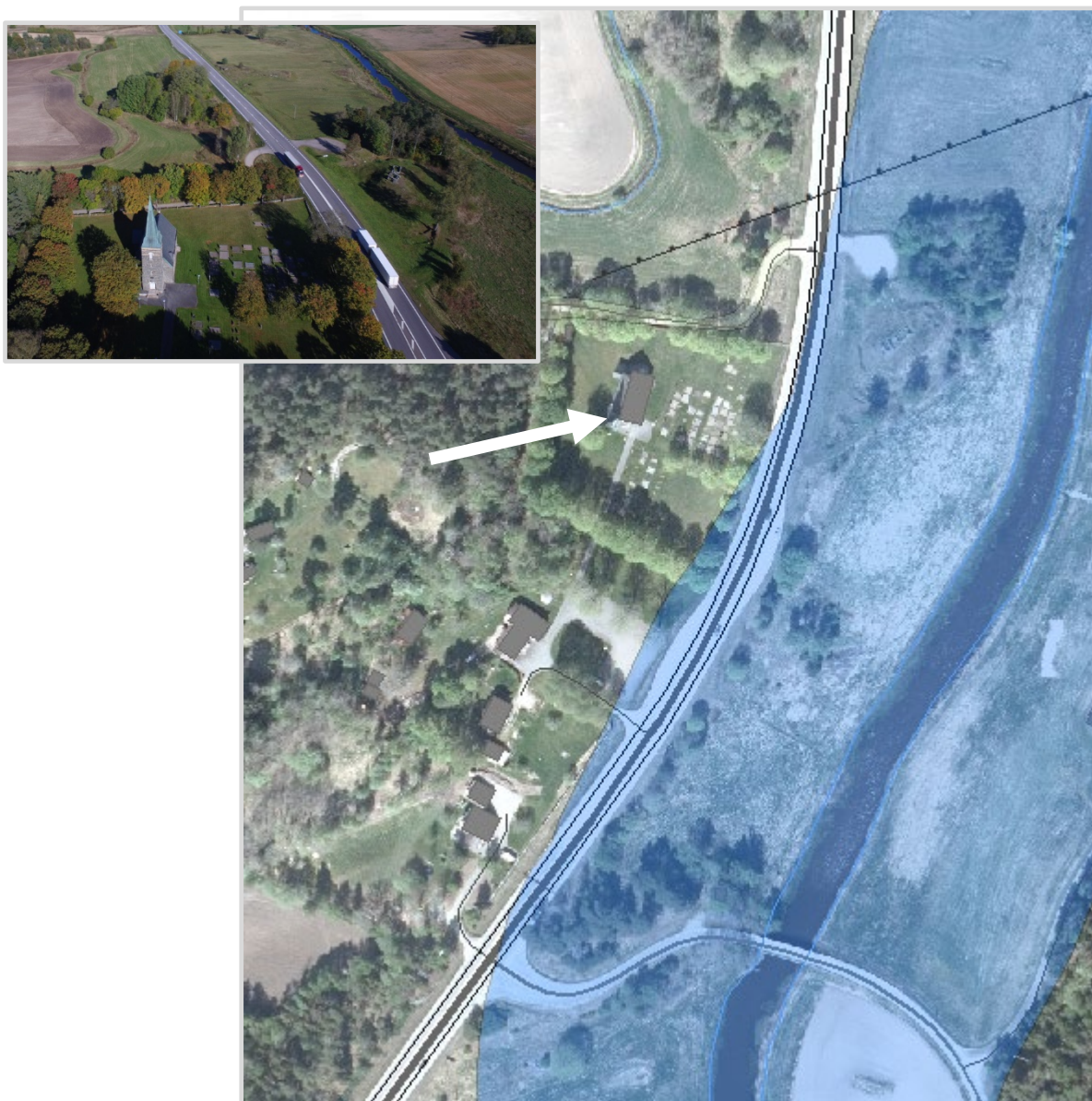
Nossan vid Södra Härene kyrka (pilen). Befintlig E20 byggs om till lokalväg. En del av sträckningen hamnar inom strandskyddat område som illustreras som blåskuggat område. Övriga ritade linjer markerar väg-/arbetsområde.
