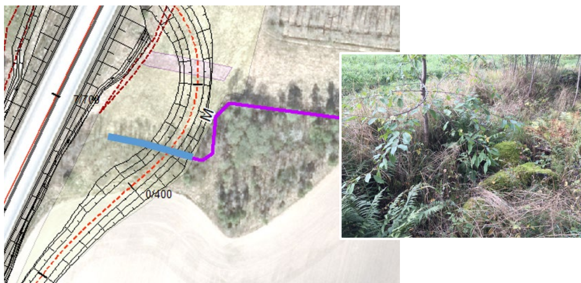
Objekt M. Relativt igenvuxet dike i jordbrukslandskap. Lila linje visar diket. Blå linje visar den del av diket som berörs av vägprojektet. Övriga ritade linjer markerar väg-/arbetsområde.
