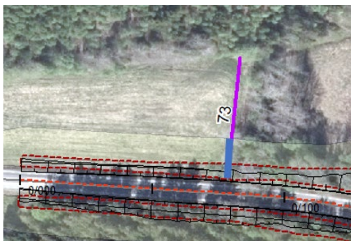
Objekt 73. Öppet dike. Lila linje visar diket. Blå linje visar den del av diket som berörs av vägprojektet. Övriga ritade linjer markerar väg-/arbetsområde.
