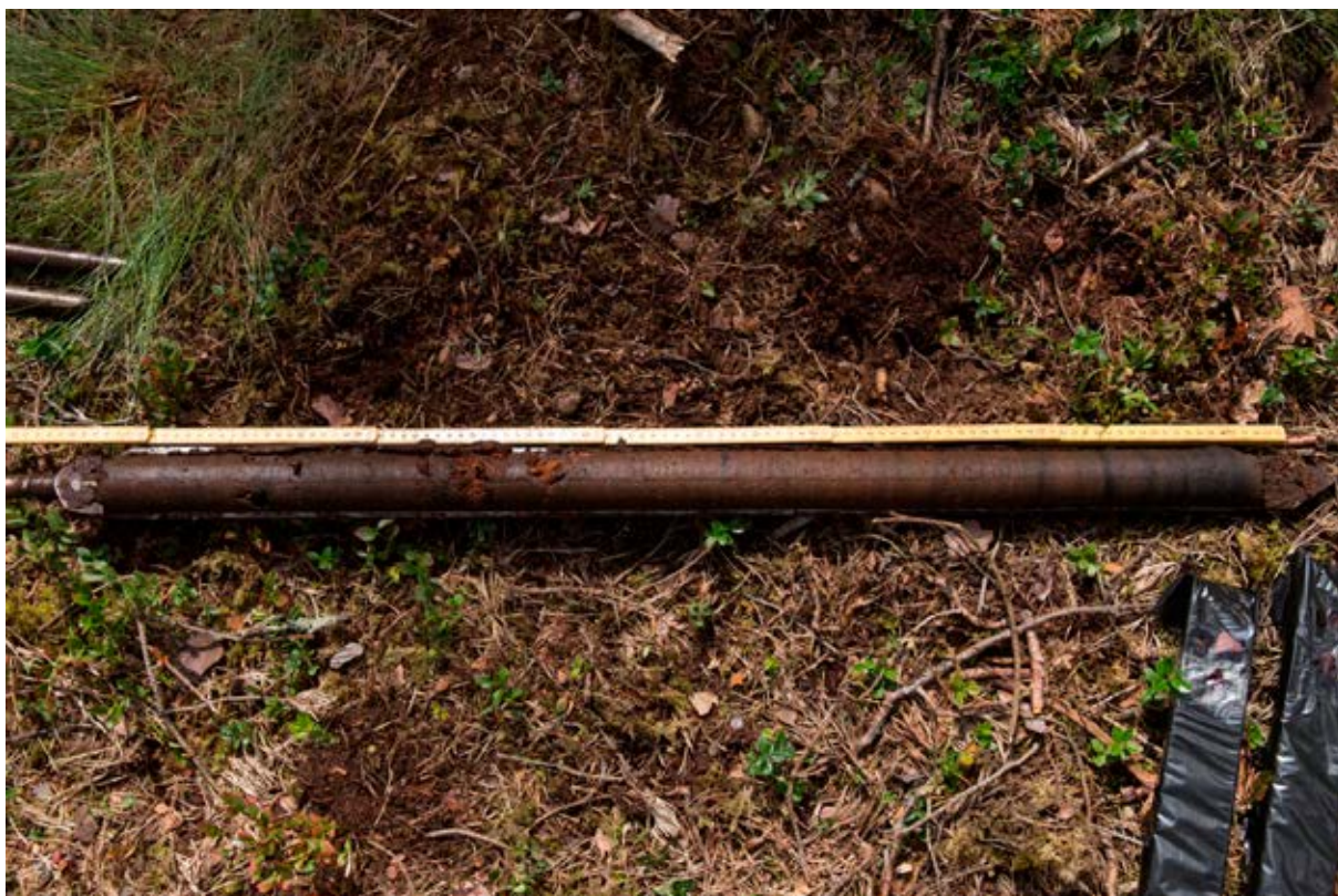
Figur 3. Det nedersta borrhsegmentet (239–339 cm). I den nedre (högra) delen syns flera kollager som svarta band. Foto Per Lagerås.
