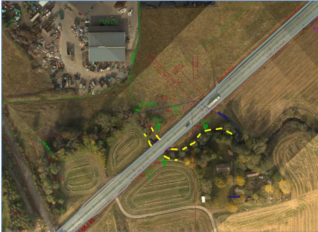
Figur 9. Preliminär skiss över erosionsskyddets utbredning i Afsåns norra fåra.
