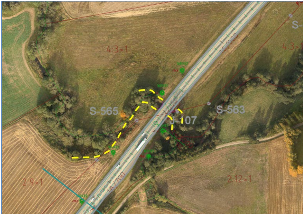
Figur 7. Preliminär skiss över erosionsskyddets utbredning i Afsåns södra fåra.
