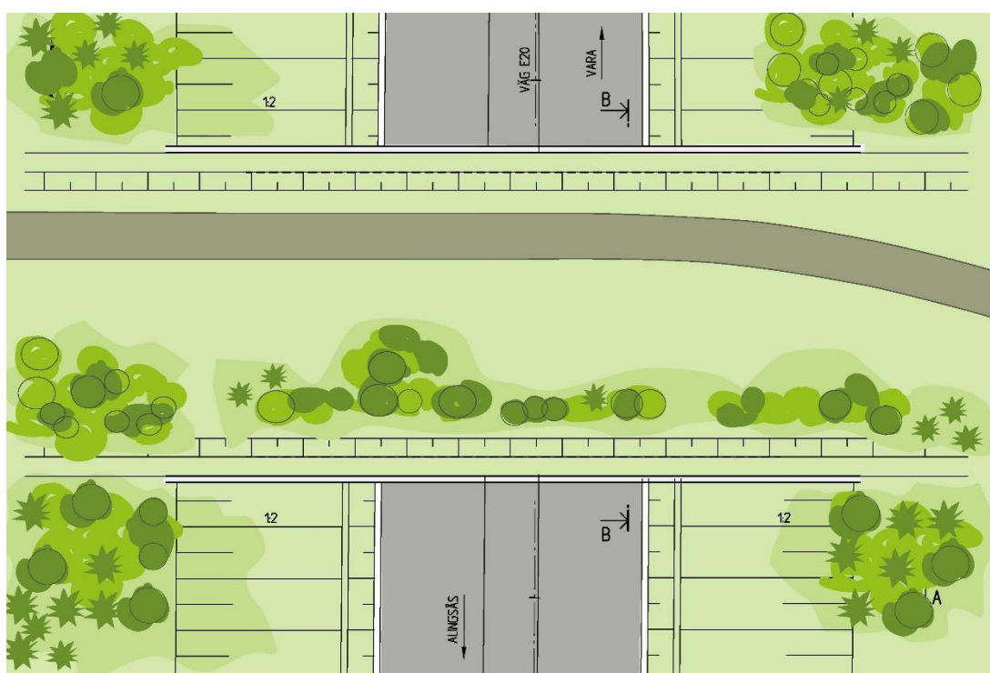
Figur 4.2.2:2 Planskiss (ovanifrån) faunapassage på bro över E20.
