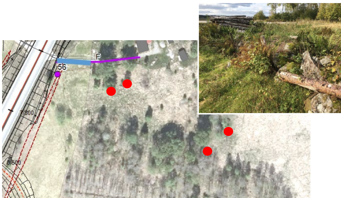
Objekt F. Stenmur. Blå del tas bort. Stenarna kan användas för att restaurera kvarvarande del av stenmuren. Annars kan stenarna användas till rösen i några av föreslagna lägena (röda prickar) eller i liknande lägen. I kartan syns även objekt 56 (odlingsröse, lila punkt). Övriga ritade linjer markerar väg-/arbetsområde.
