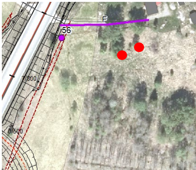
Objekt 56. Odlingsröse (lila punkt). Stenarna kan användas till restaurering av den del av stenvuren (objekt F, lila linje) som blir kvar eller till ett nytt röse i något av föreslagna lägen (röda punkter) eller i liknande lägen. Övriga ritade linjer markerar väg-/arbetsområde.
