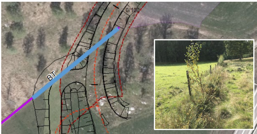
Objekt BT. Öppet dike (lila linje). Blå linje visar den del av diket som berörs av vägprojektet. Övriga ritade linjer markerar väg-/arbetsområde.
