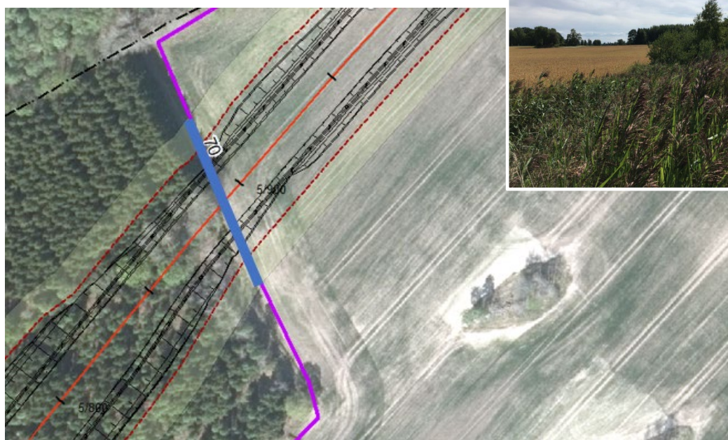
Objekt 70. Öppet dike genom åkermark. Lila linje visar diket. Blå linje visar den del av diket som berörs av vägprojektet. Övriga ritade linjer markerar väg-/arbetsområde.
