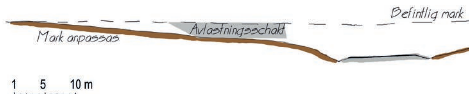
Bild 7. Exempel på utformning landskapsanpassning av avlastningsschakt.
