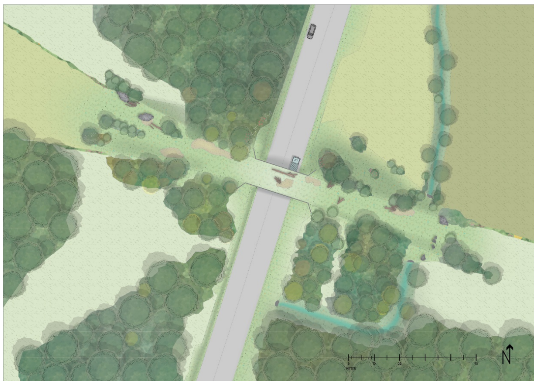
Figur 22. Exempel på utförande av faunapassage.
