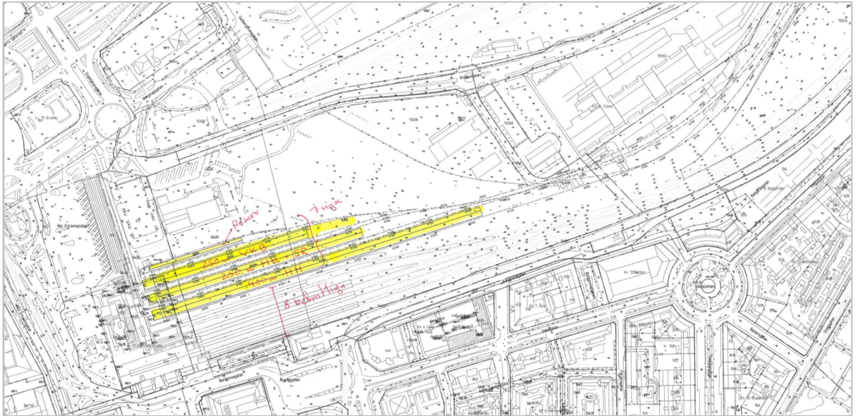
Figur 17. Schematisk skiss över nuvarande spår och plattformar och i gult förslag på tillkommande plattformar på Göteborg C ( Rapport Plattformar för 400m långa tåg ).
