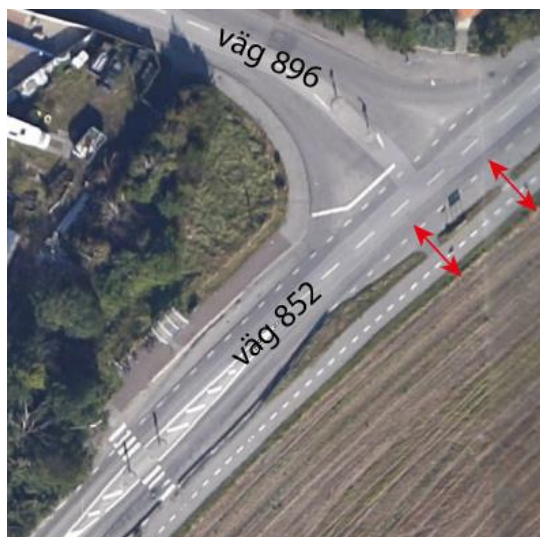
Figur 12 Röda pilar visar öppning i skiljeremsan.
