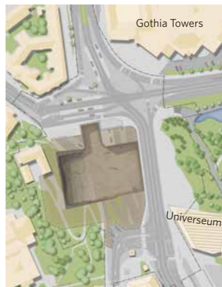
Etapp 2 Korsvägen Schaktet på den västra sidan under åren 2020-2024. Hela knutpunkten har flyttats mot Skånegatan. Trafiklösningen för etappen kan du läsa mer om i nästa nummer.
