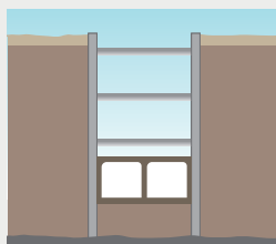
5. Gjutning av betongtunnel.
