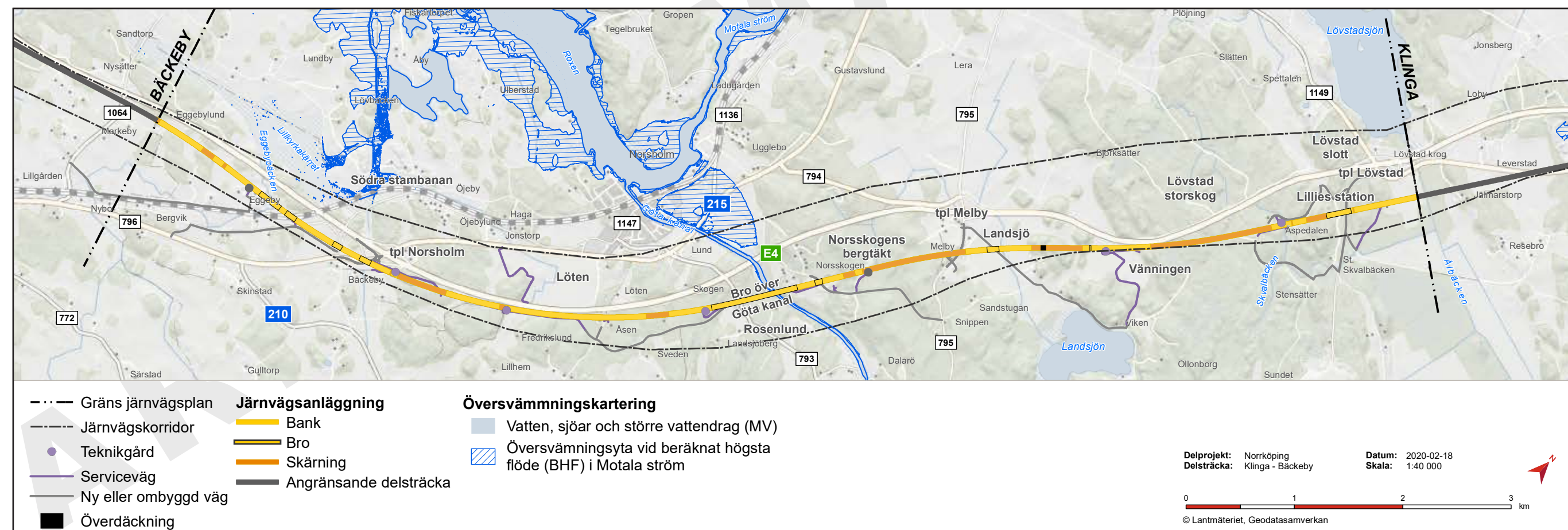
Figur 80. Förutsättningar översvämningsrisk, maximal vattenutbredning vid ett beräknat högsta flöde (BHF) i Motala ström.
