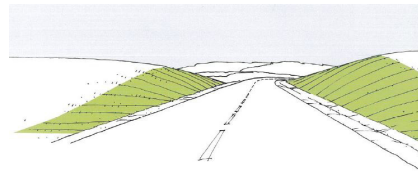
Bild 15. Propellerbladsslänter ger en mjuk anpassning mot omgivande terräng.
