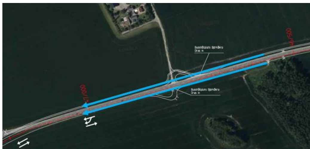
Bild 6 Avrinning västerut mot lågpunkt i sektion 47/030
