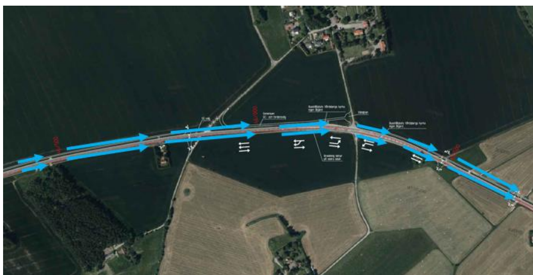
Bild 5 Avrinning österut mot lågpunkt i sektion 45/270
