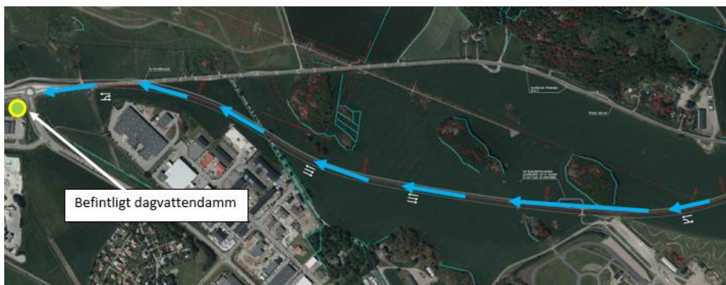
Bild 8 Principiell avrinning västerut mot befintlig dagvattendamm
