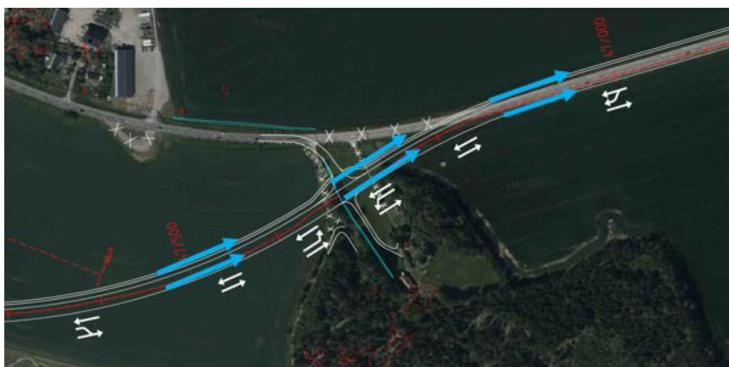
Bild 7 Avrinning österut mot lågpunkt i sektion 47/030
