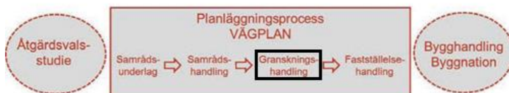
Figur 1. Planläggningsprocessen för vägplaner. Projektet "Väg 262 Danderyd – Rösjön, gång- och cykelväg" befinner sig just nu i skedet för granskningshandling.
