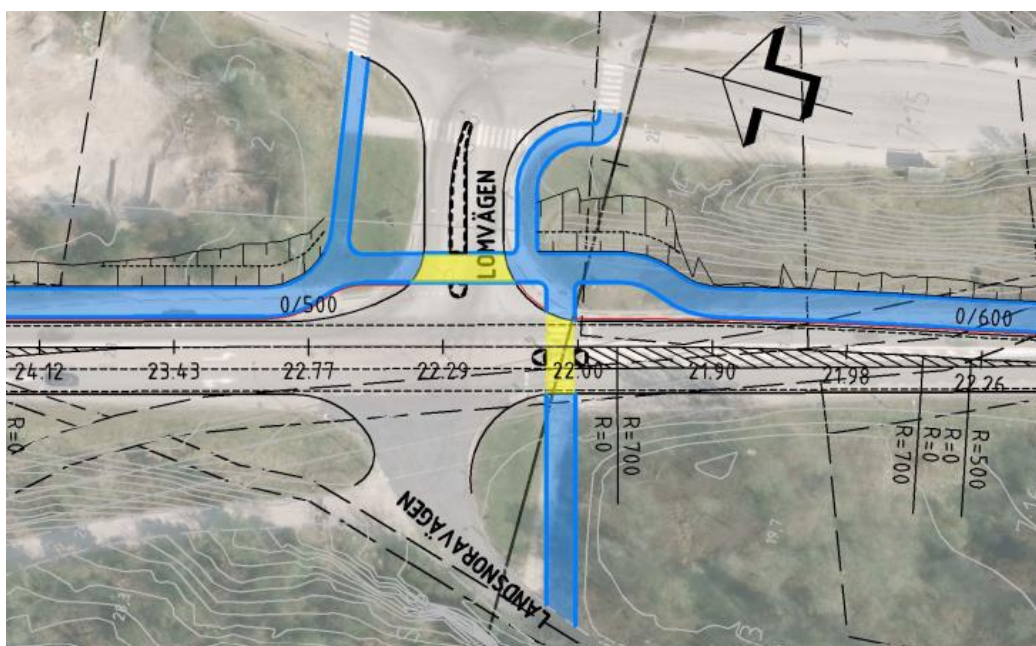
Figur 15. Ny gång- och cykelbana i korsningen väg 262/Landsnoravägen/Lomvägen åskådliggörs med blått respektive gult, där blått visar ny gång- och cykelväg och gult visar passager i plan/övergångsställen. Röd linje visar nytt vägräcke.
