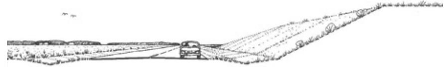
Illustration över slänt med skarp släntrön (Hermansson 1999).
