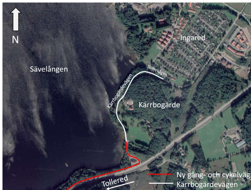
Figur 27. Delen Kärrbogärde – Ingared, gång- och cykelvägen ansluts till Kärrbogärdevägen vilket redovisas med vitt streck.
