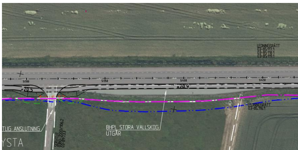
Figur 10. I denna ändring av vägplan stängs en del busshållplatser. Ovan redovisas hur gång- och cykelvägen passerar en stängd hållplats där hållplatsen får fortsatt funktion som en "rastplats" för oskyddade trafikanter. Hållplatsen på motsatt sida om väg 600 kommer att kvarstå med funktionen parkeringsficka för fordonstrafiken. Mörkblå linje visar gräns för befintligt vägområde, lila linje visar gräns för nytt vägområde och grön linje visar gräns för tillfällig nyttjanderätt.
