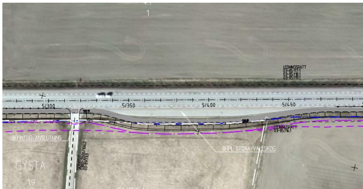
Figur 9. I tidigare fastställd vägplan ingick inga stängningar av busshållplatser och gång- och cykelvägen passerade bakom hållplatsen. Mörkblå linje visar gräns för befintligt vägområde, lila streck-prickad linje visar gräns för nytt vägområde och lila streckad linje visar gräns för tillfällig nyttjanderätt.
