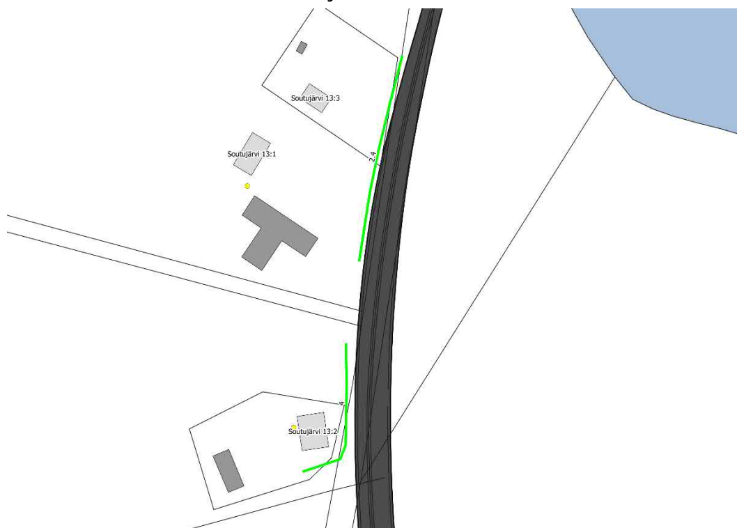
Figur 7.7: Utredd bullerskydd längs med E10:an. Gröna linjer är utredda bullerskyddsskärmar och orangea linjer är bullerskyddsvallar.
