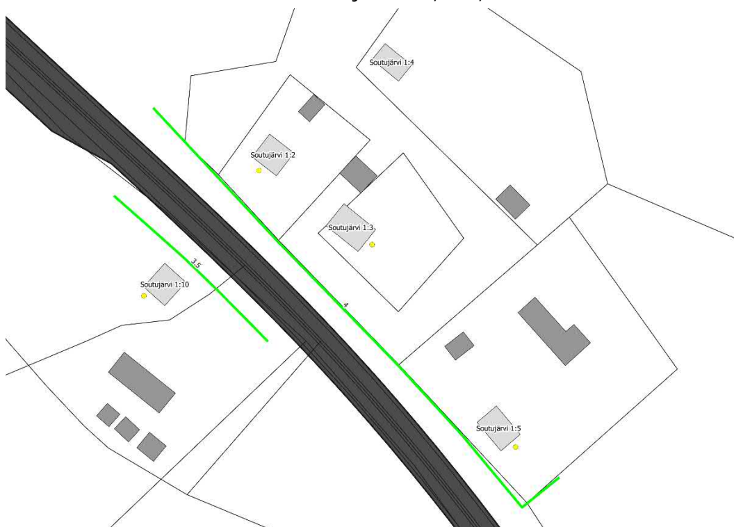
Figur 7.9: Utredd bullerskydd längs med E10:an. Gröna linjer är utredda bullerskyddsskärmar och orangea linjer är bullerskyddsvallar.
