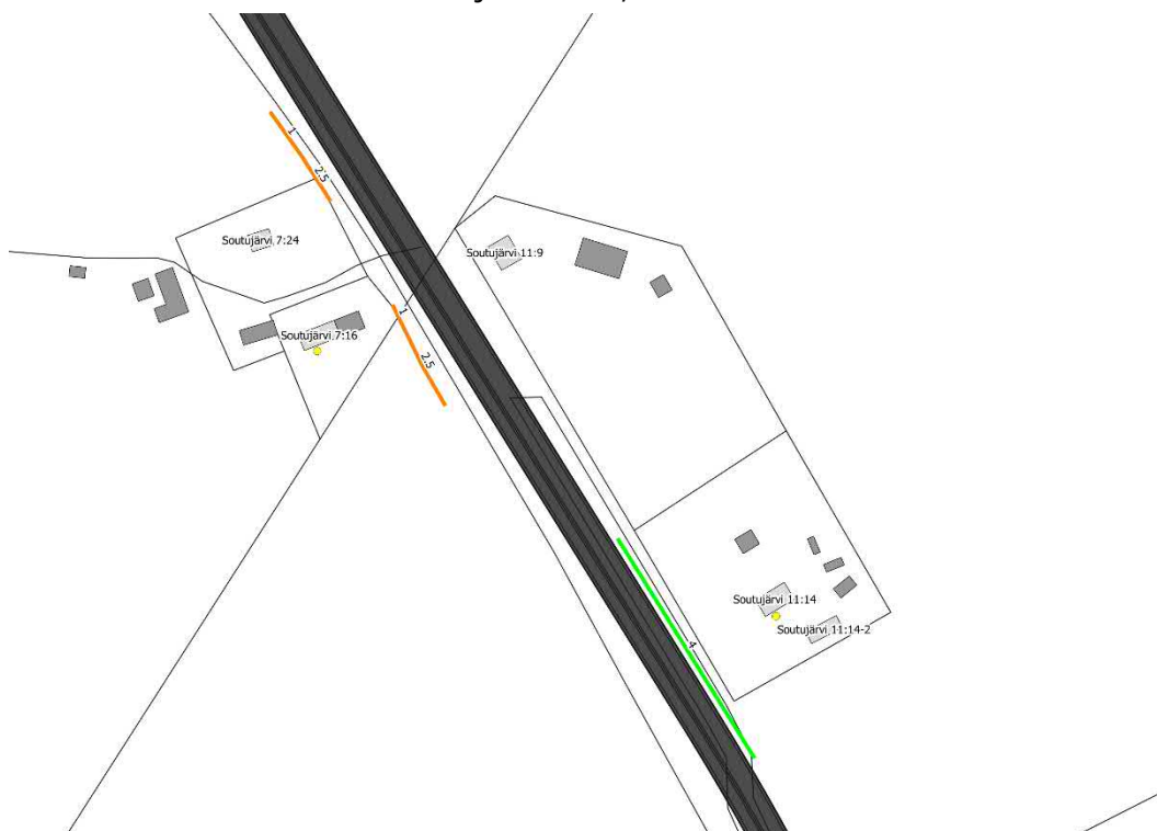
Figur 7.8: Utredd bullerskydd längs med E10:an. Gröna linjer är utredda bullerskyddsskärmar och orangea linjer är bullerskyddsvallar.
