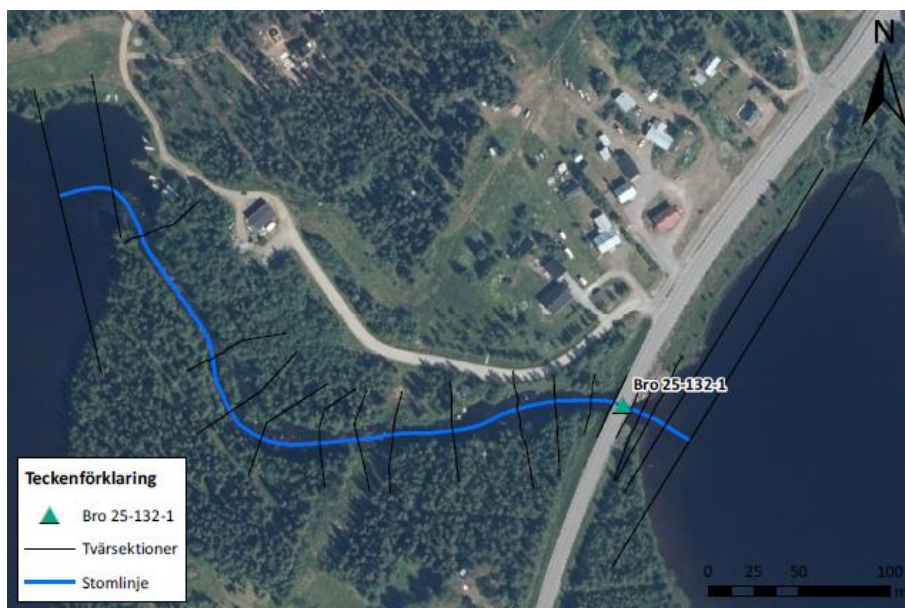
Figur 4. Den blå linjen visar den hydrauliska modellens sträckning, från precis uppströms bro 25-132-1 ner till inloppet i sjön Soutujärvi. De svarta linjerna visar de 19 st. tvärsektioner som beskriver vattendraget.
