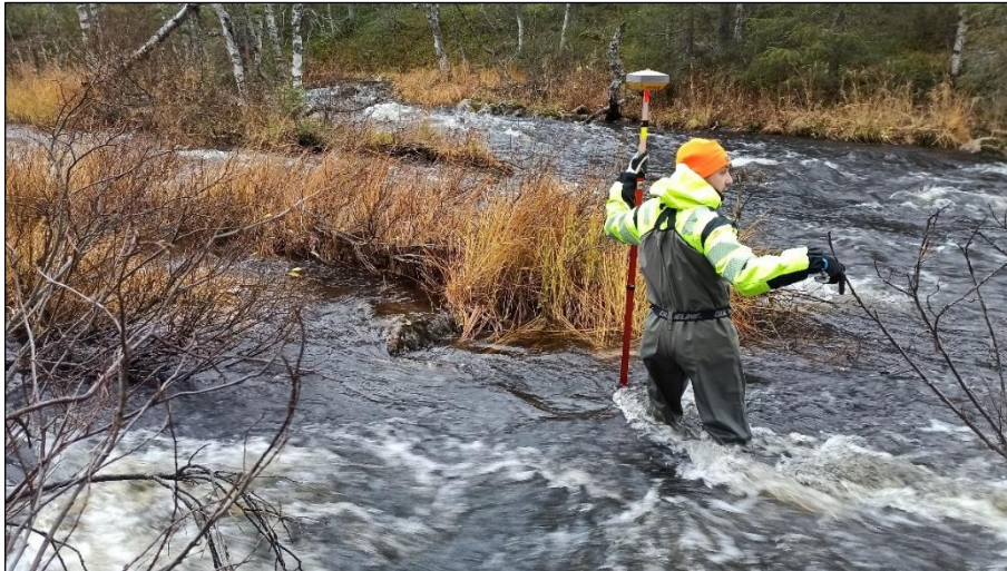
Figur 9. Fotot är taget i de nedre delarna av forssträckan lokaliserad mellan längdkoordinat 170 m (ca 130 m nedströms bro 25-132-1) och längdkoordinat 380 m. I tvärsektionerna lokaliserade i det här området ansattes Mannings tal till 20 \text{ m}^{1/3}/\text{s} . Foto: Robert Rachwalski, Sweco Polen.
