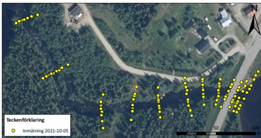
Figur 3. De gula punkterna representerar platserna där inmätningar av bottennivåer utfördes den 5:e oktober 2021.
