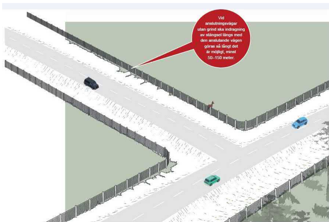
Figur 11. Illustration av indragning av stängsel på anslutande väg.
