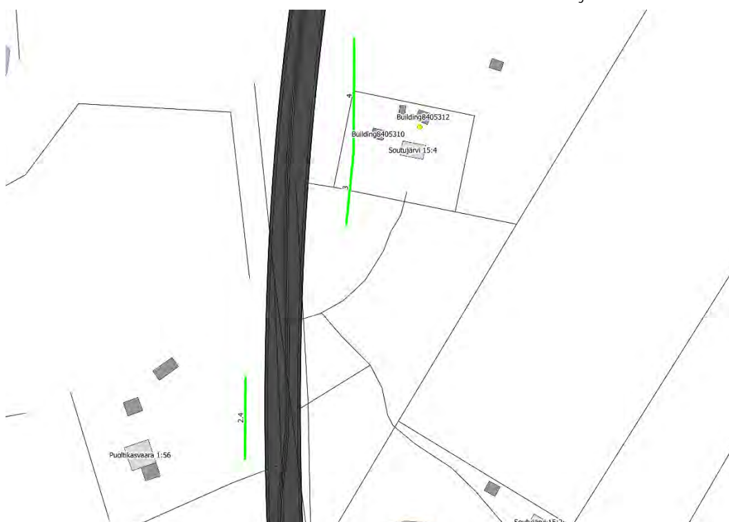
Figur 7.11: Utredd bullerskydd längs med E10:an. Gröna linjer är utredda bullerskyddsplank och orangea linjer är bullerskyddsvallar.
