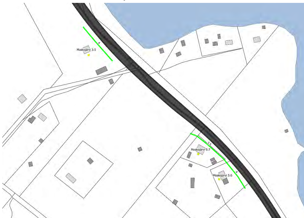
Figur 7.4: Utredd bullerskydd längs med E10:an. Gröna linjer är utredda bullerskyddsskärmar och orangea linje är bullerskyddsvallar.
