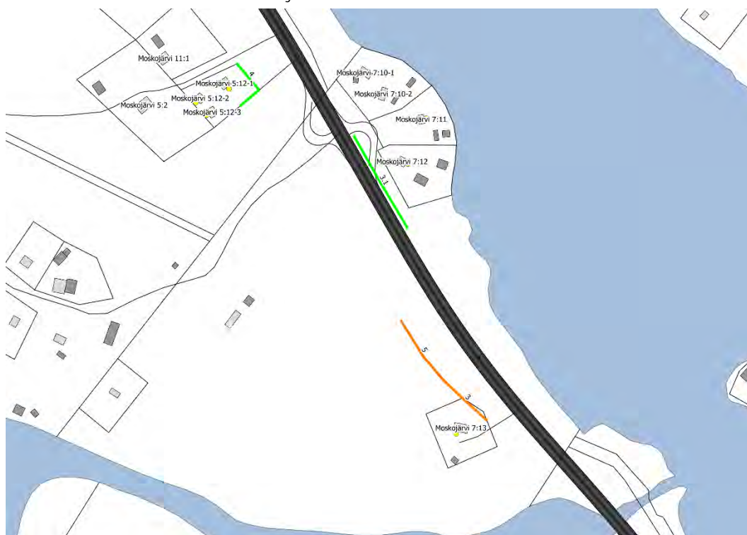
Figur 7.3: Utredd bullerskydd längs med E10:an. Gröna linjer är utredda bullerskyddsskärmar och orangea linje är bullerskyddsvallar.
