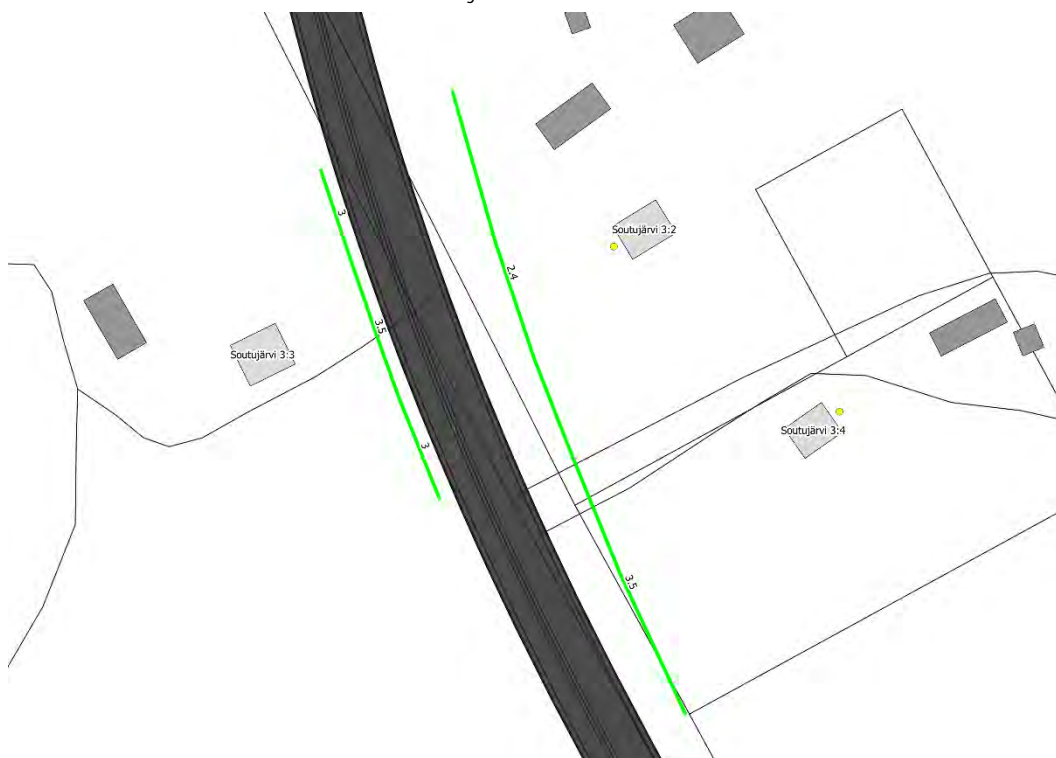
Figur 7.6: Utredd bullerskydd längs med E10:an. Gröna linjer är utredda bullerskyddsskärmar och orangea linjer är bullerskyddsvallar.
