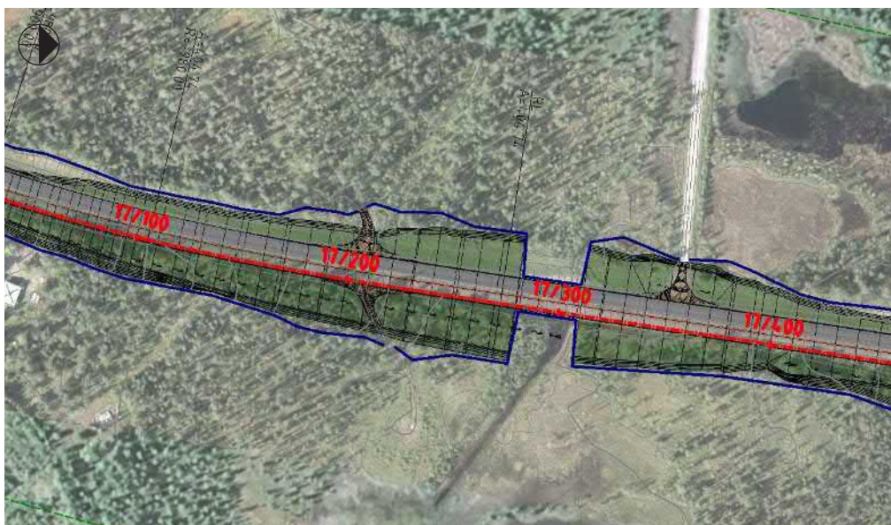
Figur 27. Föreslagen placering av faunapassage söder om Lappeasuando, sektion 17/300. Släntutformningen är schematisk och ska utvecklas och anpassas i byggskedet.
