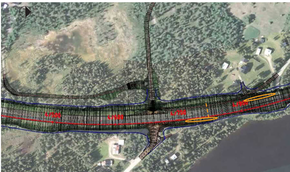
Figur 18. C-korsning i södra Moskojärvi där nya busshållplatser, se orange cirkel, föreslås anläggas på respektive sida E10 med tillhörande gångvägar. Förslagen gångpassage över E10 illustrerad med orange streckad linje. Blå linje illustrerar ungefärlig placering av viltstängsel.
