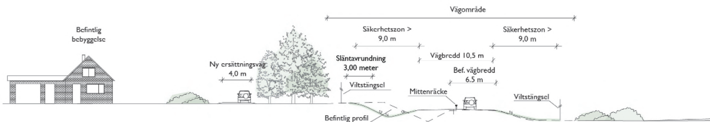
Figur 13. Typsektion från områden med bebyggelse där E10 anläggs som 1+1 väg med en vägbredd på 10,5 meter.
