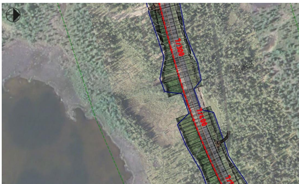
Figur 30. Föreslagen placering av faunapassage norr om Moskojärvi sektion 7/300. Släntutformningen är schematisk och ska utvecklas och anpassas i byggskedet.
