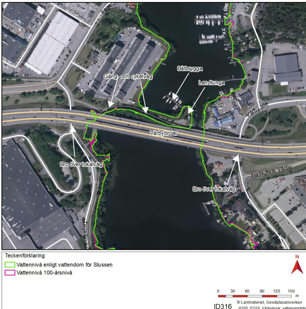
Figur 3. Geografisk avgränsning av vattenverksamheten. Åtgärder under vattennivå med 100-års återkomsttid är vattenverksamhet liksom grundvattenbortledning vid grundläggning av brostöd för broar över lokalvägarna Vårby allé och Tegelbruksvägen.
