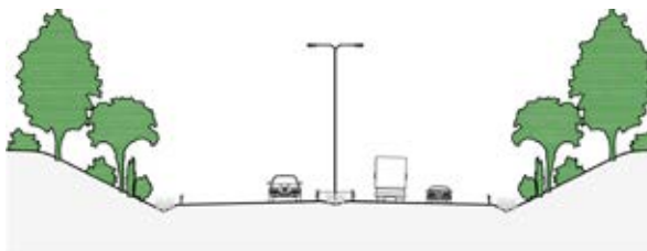
Exempel på väg i jordskärning.
