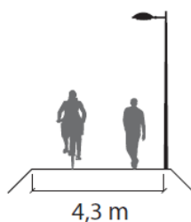
Figur 14. Typsektion för friliggande dubbelriktad gång- och cykelväg med regional standard enligt VGU.
