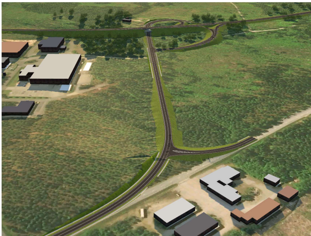
Figur 21. Modell i 3D som visar korsningen vid Bors norra industriområde och anslutningen till befintlig väg 27.
