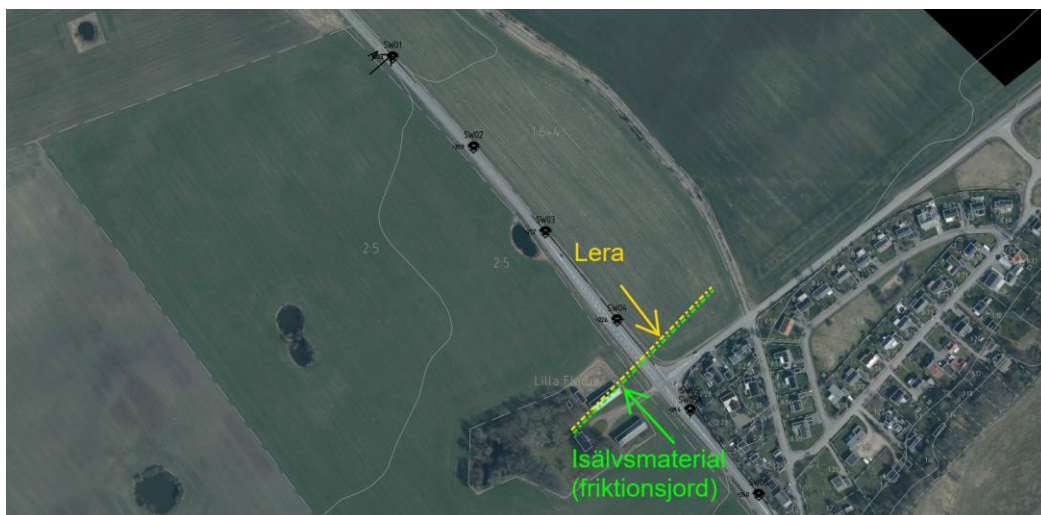
Figur 5.5.2. Ungefärlig övergång i norr mellan tät jord av lera och genomsläpplig jord av sand enligt utförd undersökning. Profil redovisas i efterföljande figur.
