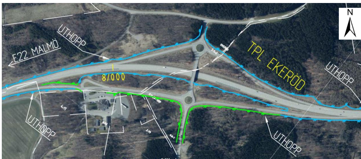
Figur 33. Andra alternativet med avseende på dragning och avslut av faunastängsel samt placering av uthopp vid trafikplats Ekeröd. Blå linje visar befintligt viltstängsel och grön linje nytt viltstängsel.
