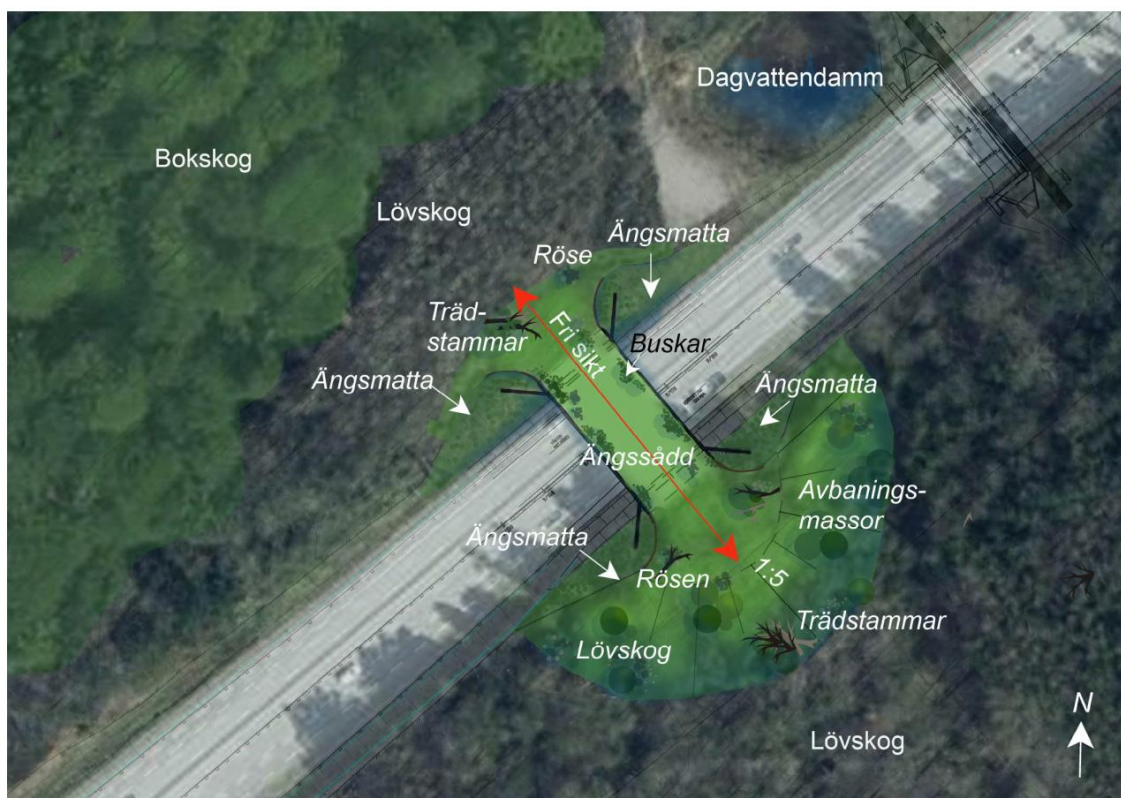
Figur 37. Principskiss över faunabrons gestaltning som visar hur lövskogen i norr bevaras samt hur mycket av skogen i söder som påverkas av nya slänter.
