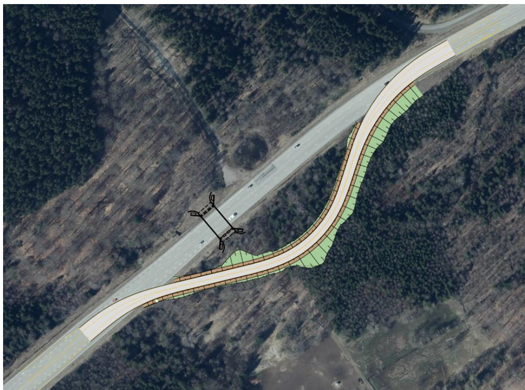
Figur 39. Principiell utformning av tillfällig förbifart söder om E22 i det aktuella läget.
