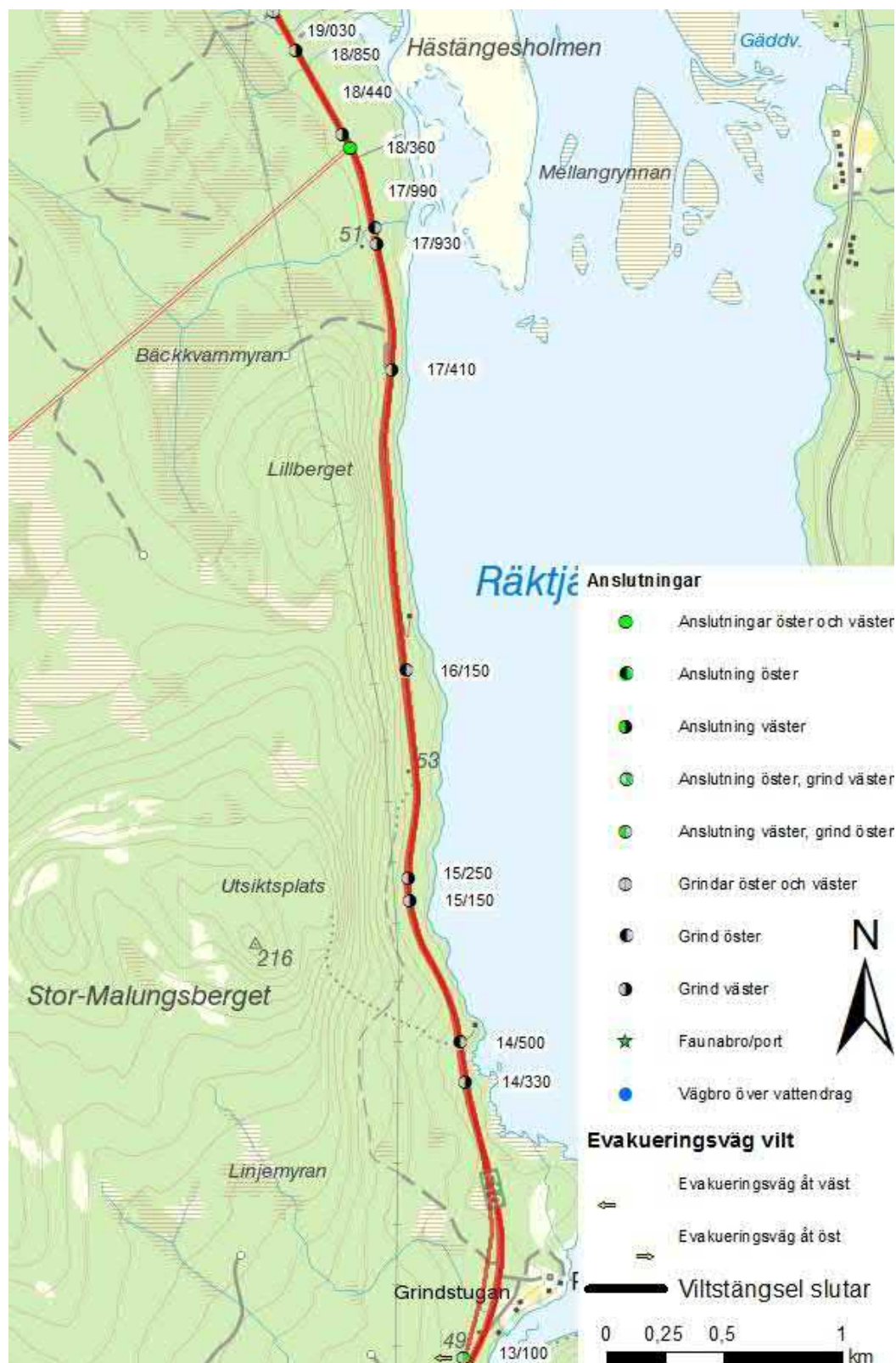
Figur 12. Anslutningar, öppningar i viltstängslet (öppna anslutningar) samt platser där evakueringslösningar för vilt bör placeras.
