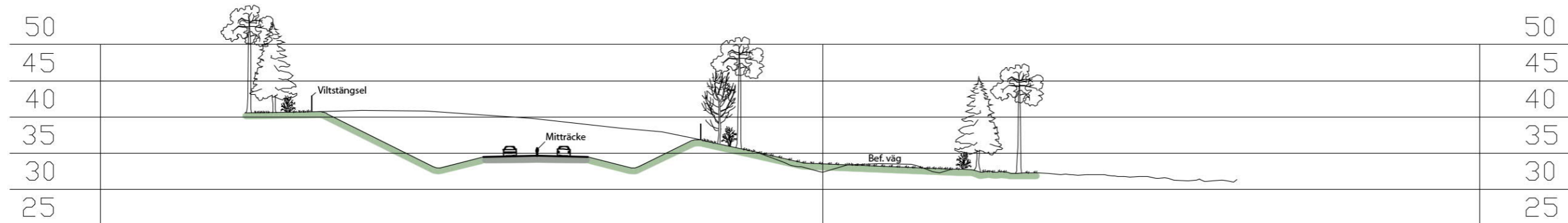
Bild 5. Ny sträckning av väg E10 för anpassning till ny bro över Kälvån. Sektion 8/200, norr om ån. Befintlig terräng som utgår visas som ljusgrå linje.
