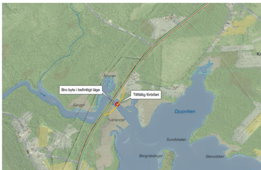
Figur 4. Skiss över läge för tillfällig förbifart vid Grundträskån
