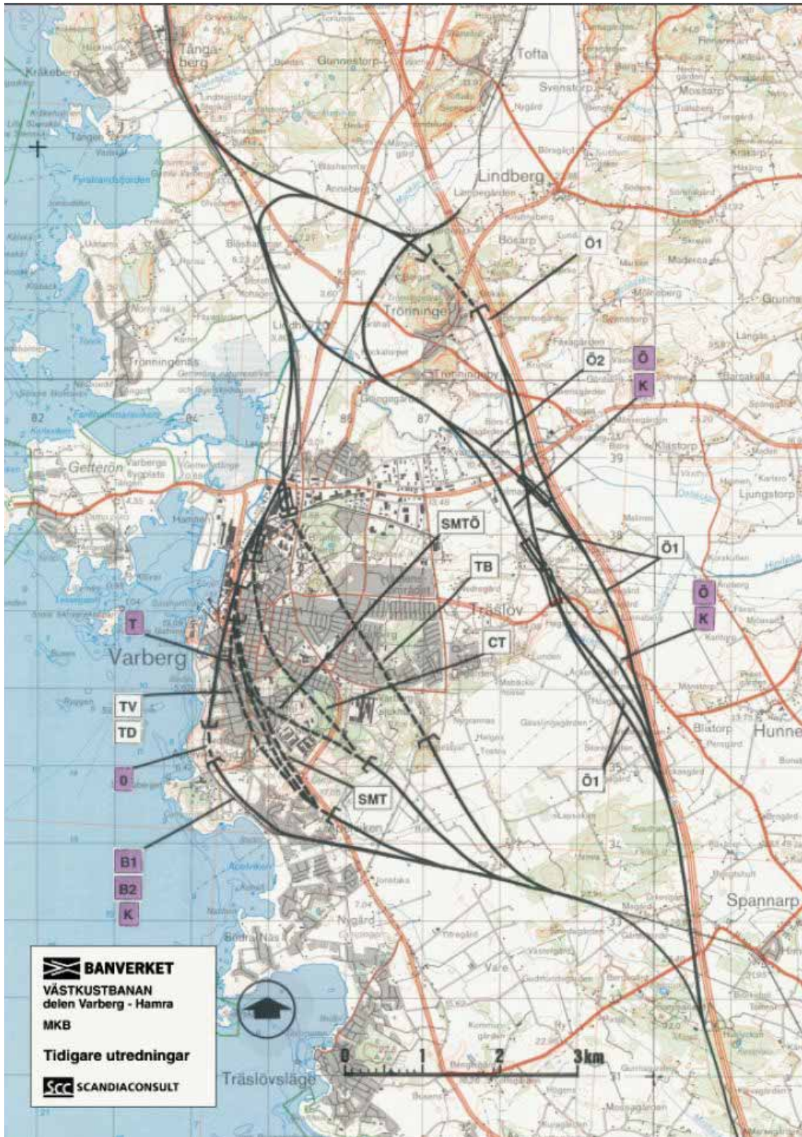
Figur 2.2 Studerade sträckningar i Banutredningen. Bokstäverna står för de olika alternativa sträckningar som studerades: Tunnel under Vallgatan (TV), Tunnel under Domus (TD), Stadsmiljöttunnel (SMT, SMTÖ), Centrumtunnel (CT), Tunnel under Brunnsberg (TB) och en östlig sträckning (Ö1, Ö2). Bild från järnvägsutredningen.
