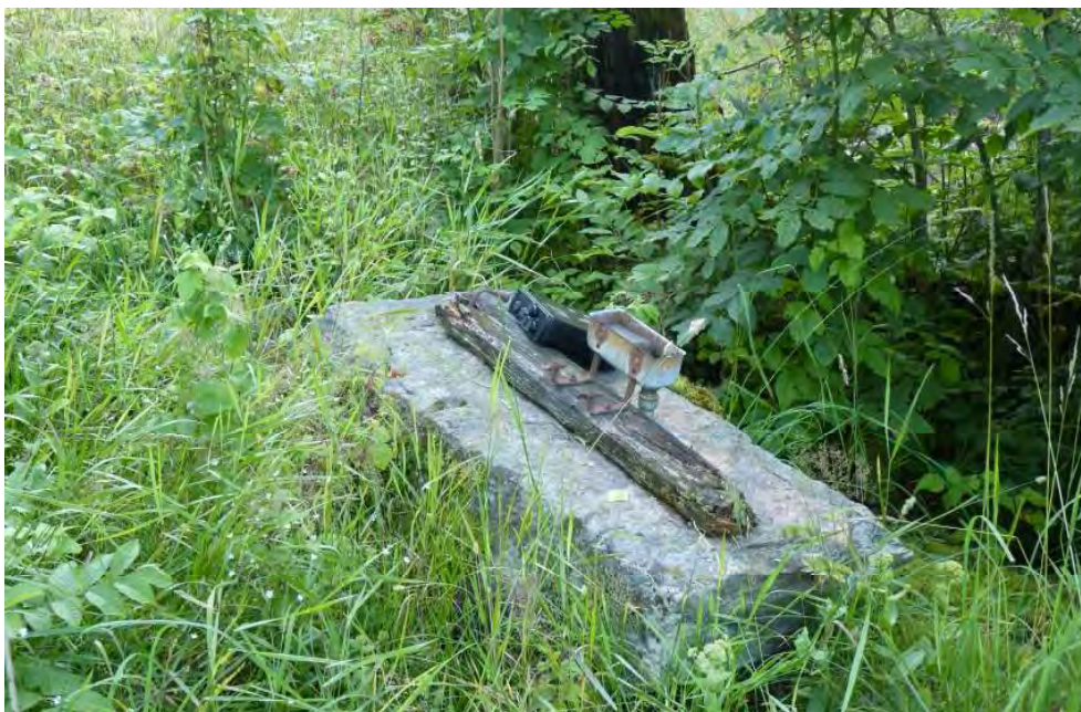
Autobox av modell D500X (den svarta lådan) utplacerad för registrering.
