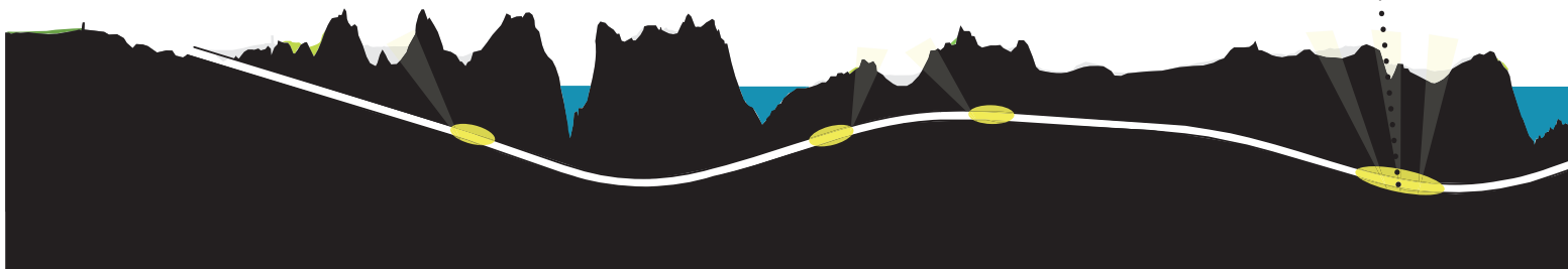
Konceptdiagram: Tunnelprofil södergående tunnel med simulerad dagsljusinstrålning vid trafikplatser och mittrummet "lungan". (Höjd är förstärkt 10 gånger längd).
