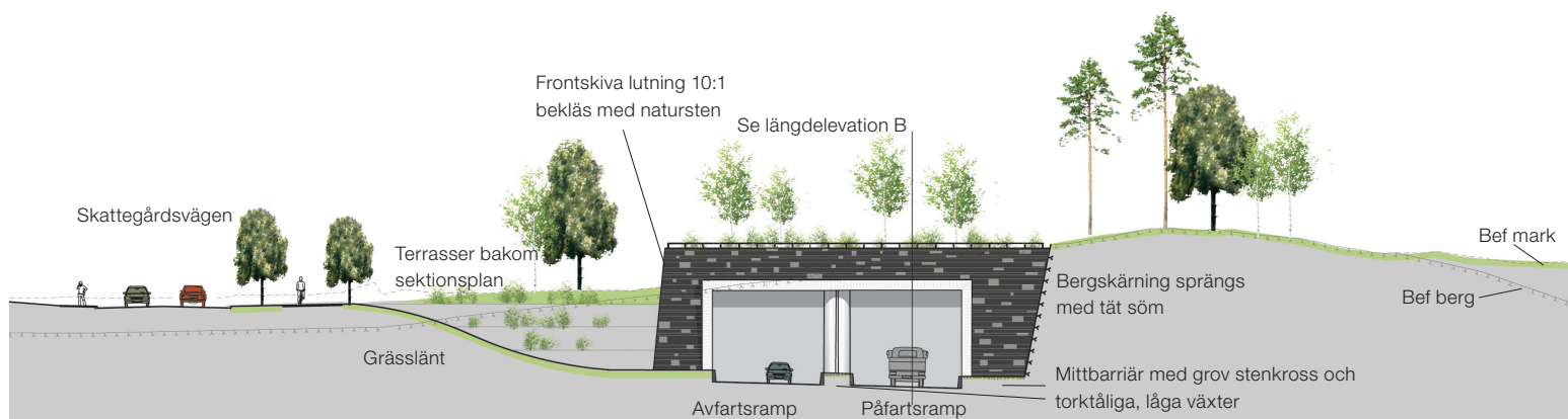
Sektion A, tunnelmynning cirkulationsplats Skattegårdsvägen.
