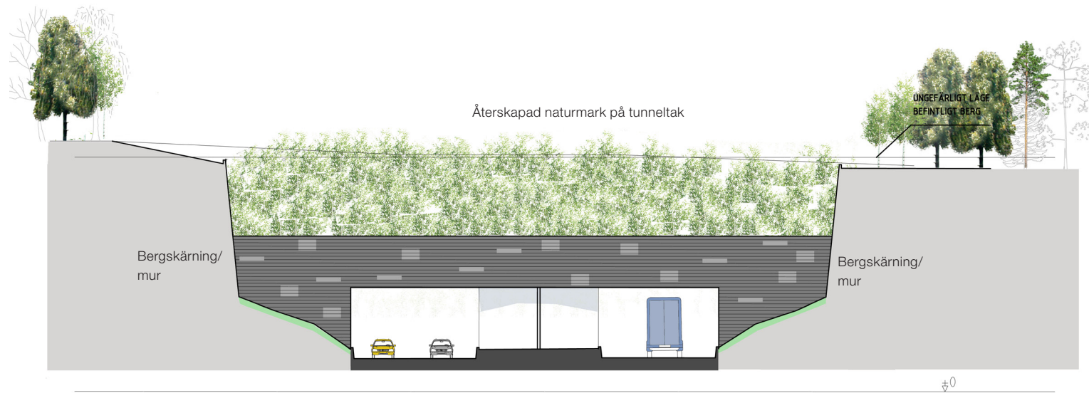
Sektion F, Tillflykten påslag, tvärsektion ramp
