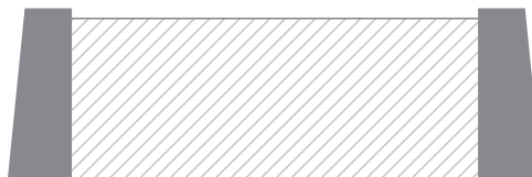
Barriärelement används som stödmur för mittremsa.
