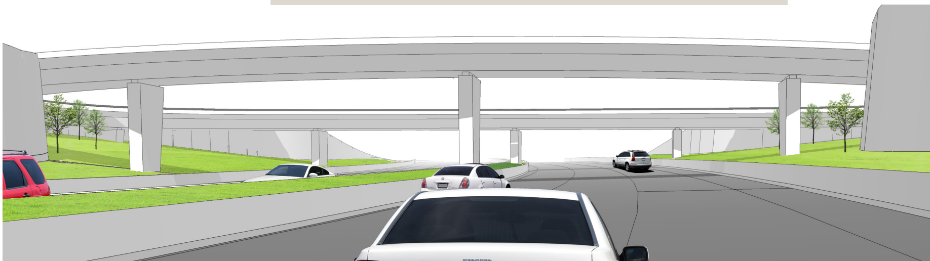
Broar i en cirkulationsplats . Skivstöden bidrar till att understödja vägens riktning.
