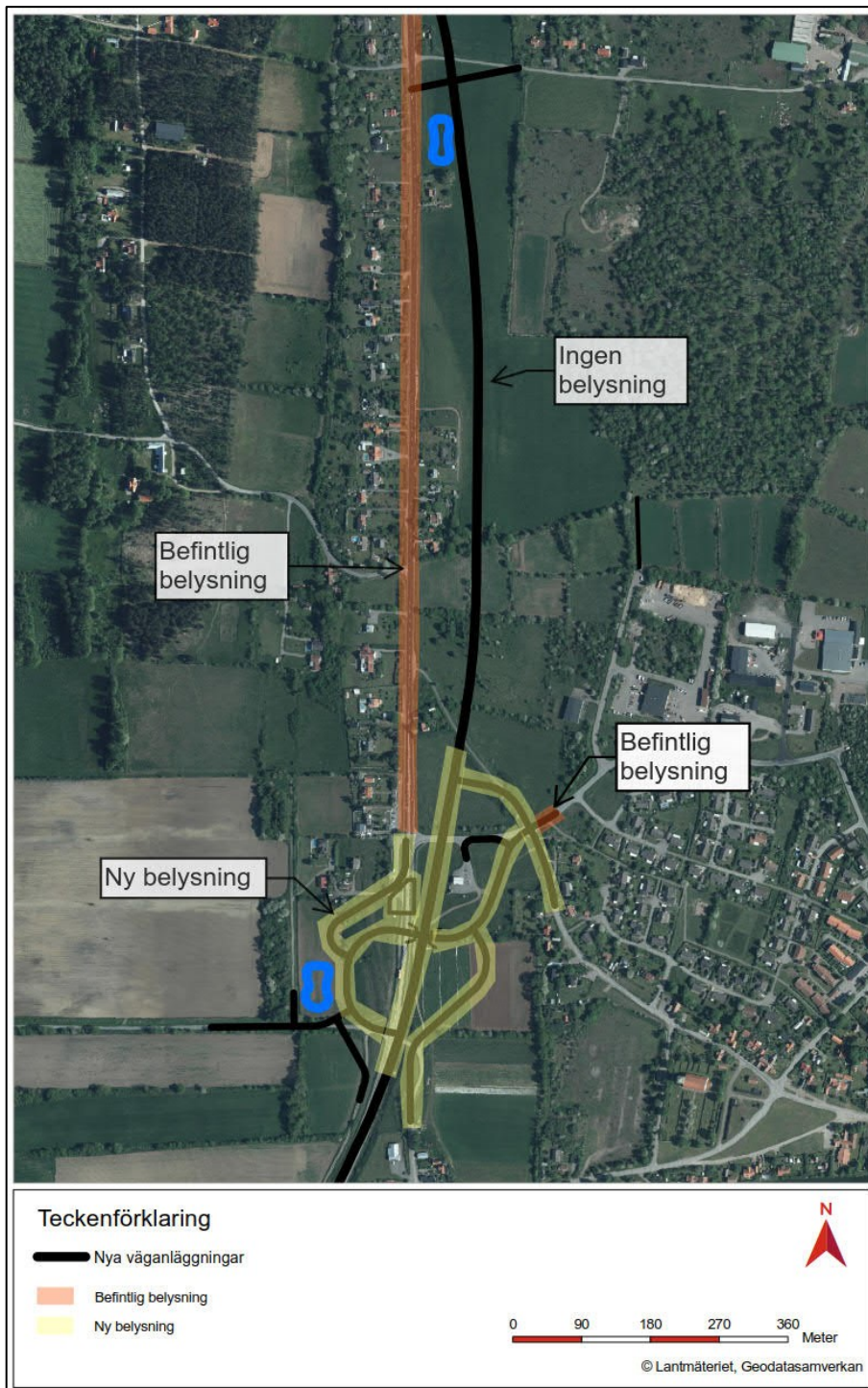
Figur 43. Översikt över belysning vid trafikplatsen i Algutsrum där ny belysning föreslås samt befintlig väg 136 där befintlig belysning blir kvar.
