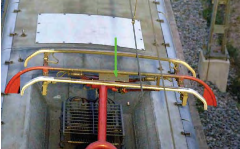
Figur 7: Exempel på bild från kolslitskenedetektor
