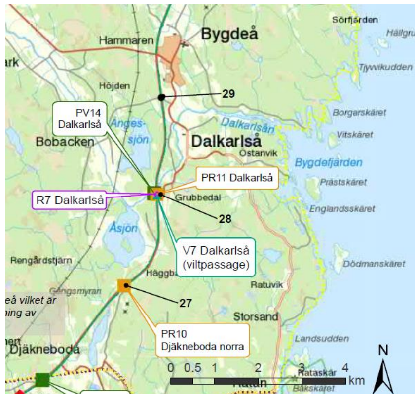
Figur 5.1-1. Utppekade förbättringsåtgärder för E4-sträckan Djäkneboda–Sikeå i studien "Stängsel och passager för ren och vilt". I denna vägplan behandlas V7 och PR10.
