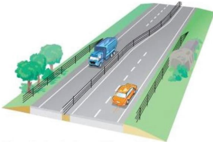
Figur 9. Illustration av mötesfri väg med omväxlande 2-1 körfält. (referens Planbeskrivningen)
