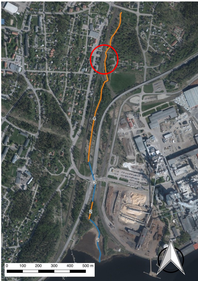
Figur 10 Sträckan av bäcken som är biotopkarterad. Den röda cirkeln visar ungefärlig utbredning av planområdet. De olika etapperna anger delar av bäcken med olika karaktär: 1) omgrävd och fördjupad genom torvmark, 2) rakgrävd kanal, 3) kulverterad och 4) kraftigt nedgrävd och utträtad.
