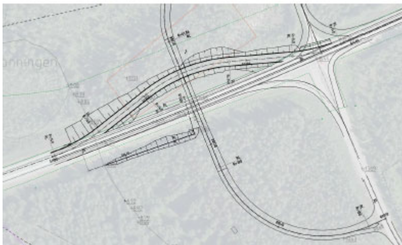
Figur 5.1-2. Tillfällig förbifart under byggskedet "Piteåsidan" (Källa: Teknisk Utredning projekt E4 Trafikplats Rosvik södra, Trafikverket 2021).
