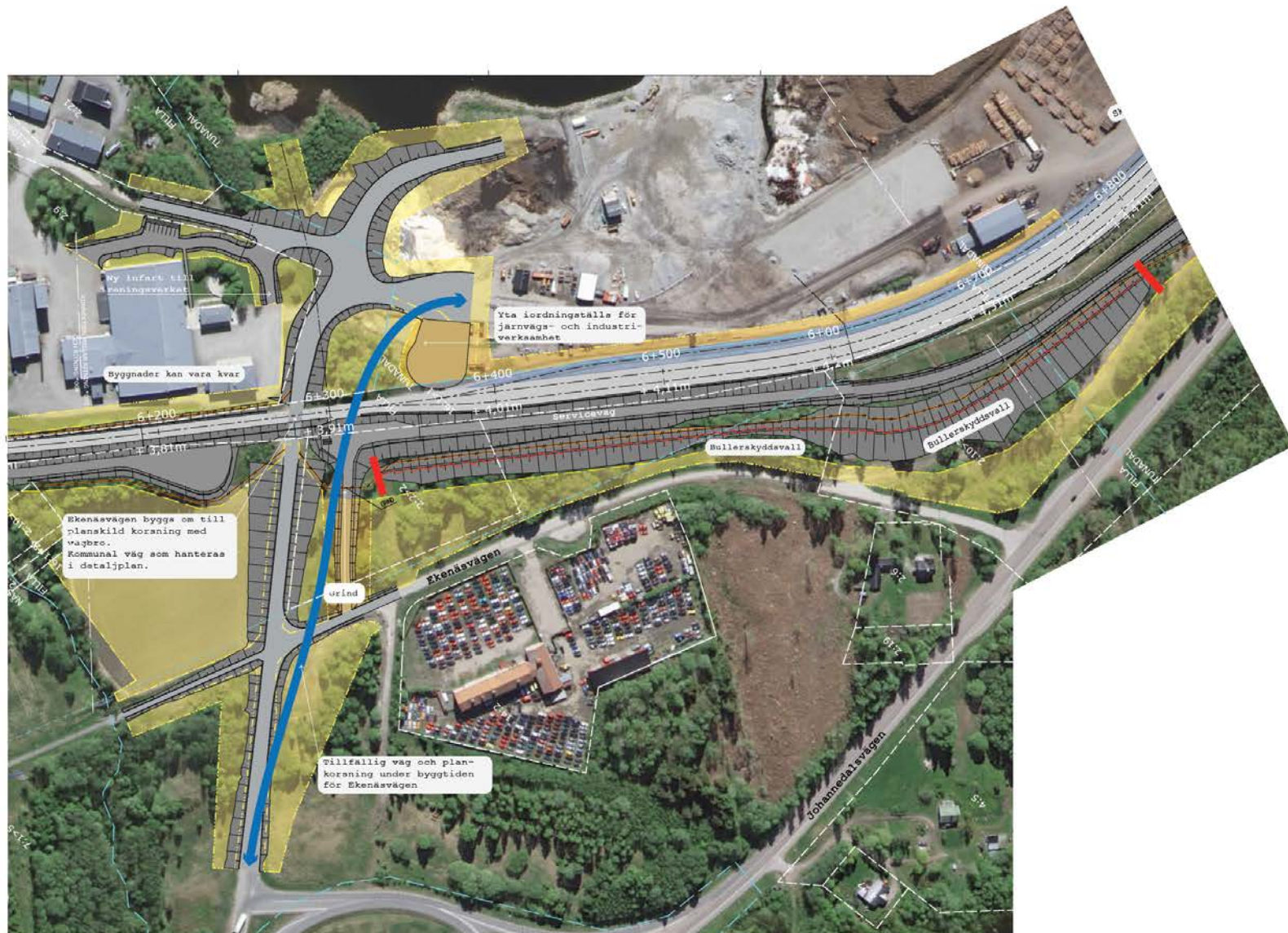
Figur 5.3:4 Bullervall anläggs vid sektion 6+320-6+790(Utsnitt från illustrationskarta samt att bullerskyddsvallen markerats med röd linje).
