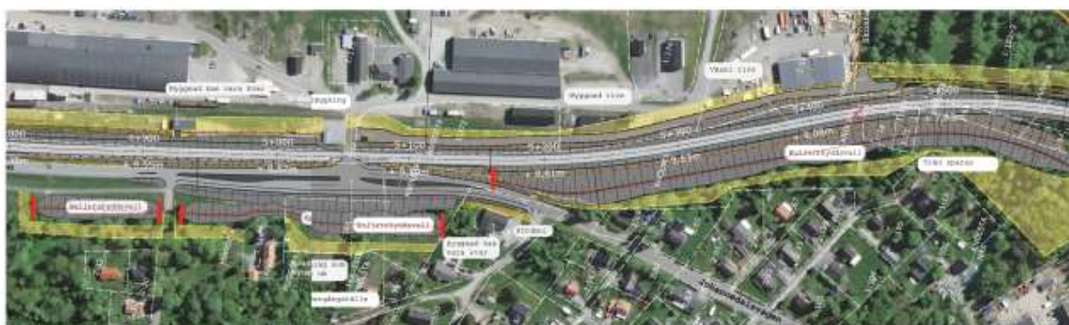
Figur 5.3:3 Bullervall anläggs vid sektion 4+820-5+130 (med avbrott för Hengårdsvägen) och vid sektion 5+170-5+610 (Utsnitt från illustrationskarta samt att bullerskyddsvallarna markerats med röd linje).
