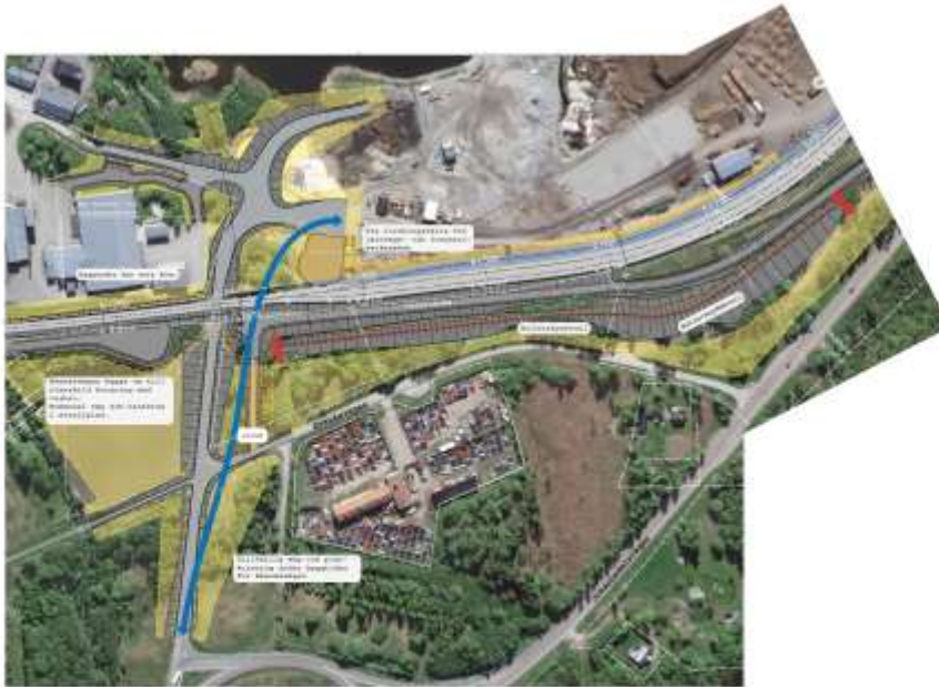
Figur 5.3:4 Bullervall anläggs vid sektion 6+320-6+790 (Utsnitt från illustrationskarta samt att bullerkyddsvallen markerats med röd linje).
