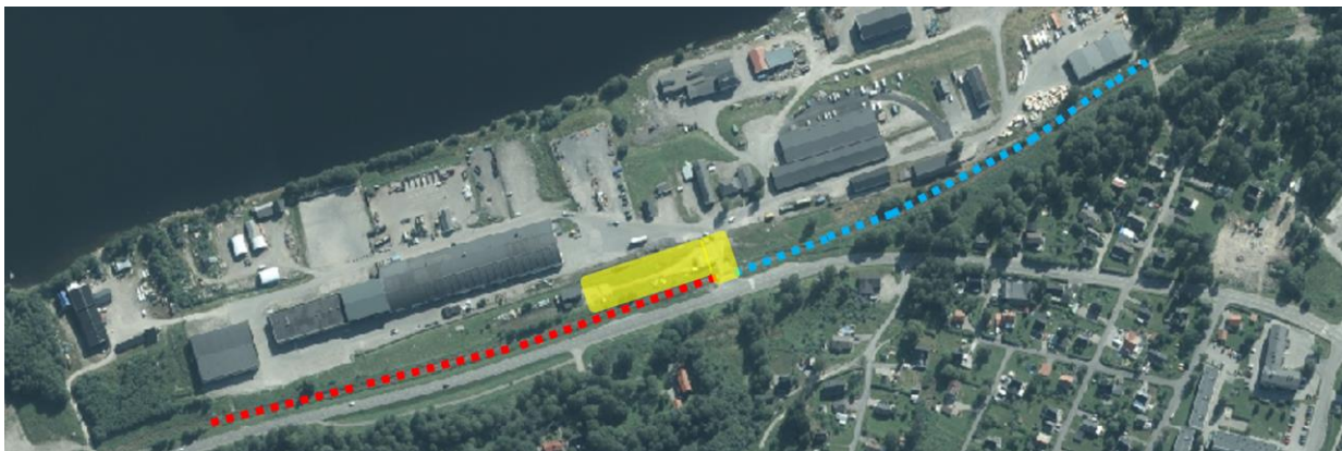
Blåmarkerad sträcka: Vagnar som rör sig framåt cirka var femte minut. Rödmarkerad sträcka: Diesellok och vagnar som rör sig framåt med samma tidsintervall. Gulmarkerat fält: Lossning och uppställning av slipers med hjullastare
